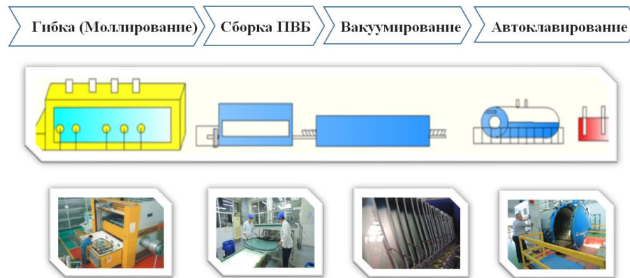
Рис.2. Технологический процесс изготовления ветровых стекол на ООО «Автоойна».
